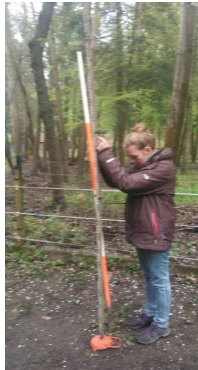
Manipulation d'une mire pour relever les mesures de niveau. A la suite de cette étape, on pourra déterminer les différences d'altitudes entre chaque point du réseau de polygones.
