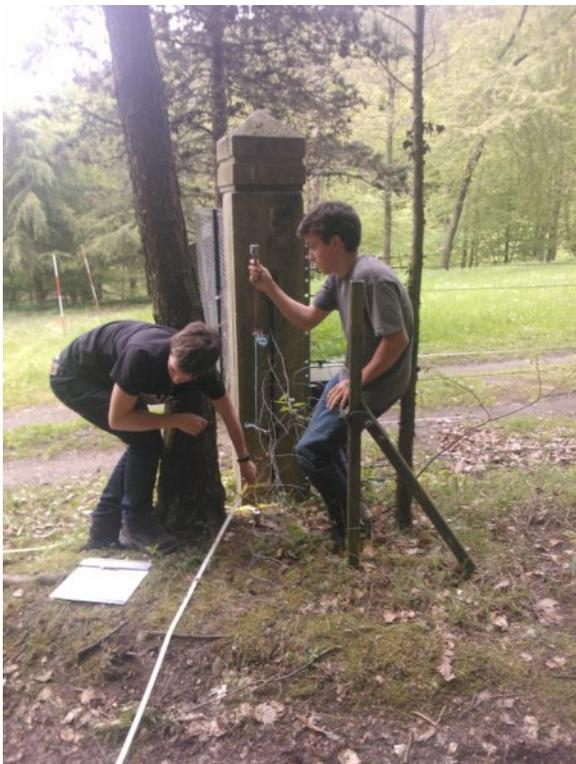
La mesure de détails s'effectue le long d'une droite reliant deux points. On vient relever à l'aide d'une équerre optique tous les éléments susceptibles d'apparaître sur la carte finale.
